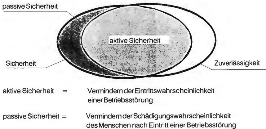
Abb. 3: Bereiche der Sicherheit und Zuverlässigkeit und deren Zuordnung zu den Begriffen "aktive" und "passive" Sicherheit
