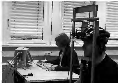
Abbildung 2: Der Blickverfolger einschließlich des Gestells zur Minimierung von Kopfbewegungen.
