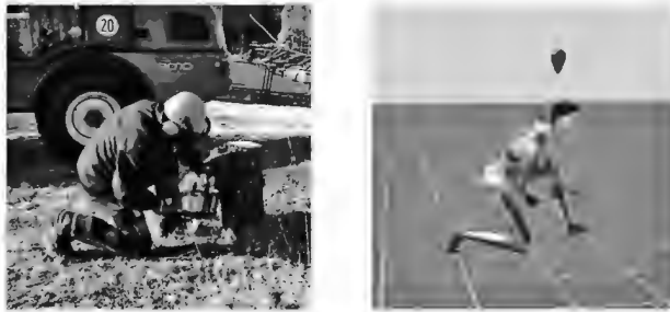
Abb. 1: Digitale Abbildung der Arbeitstätigkeit mittels Inertialsensormesssystem MVN Awinda Biomech der Firma Xsens Technologies B.V.
